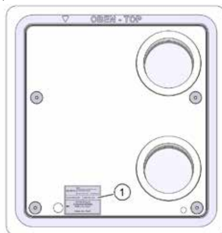
Fig. 4: Targhetta del tipo accanto al foro per il cavo di rete
