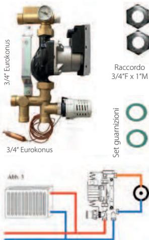
Gruppo di miscelazione tipo FRG 3005 con pompa di ricircolo, per la regolazione della temperatura di mandata in circuiti di riscaldamento a bassa temperatura, allacciamento possibile sia da destra che da sinistra
